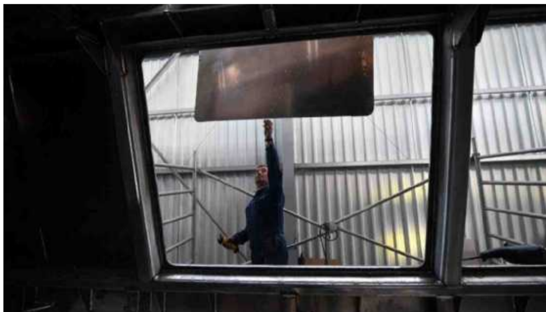
Une fois les plaques d'aluminium assemblées, les fenêtres sont découpées une à une
